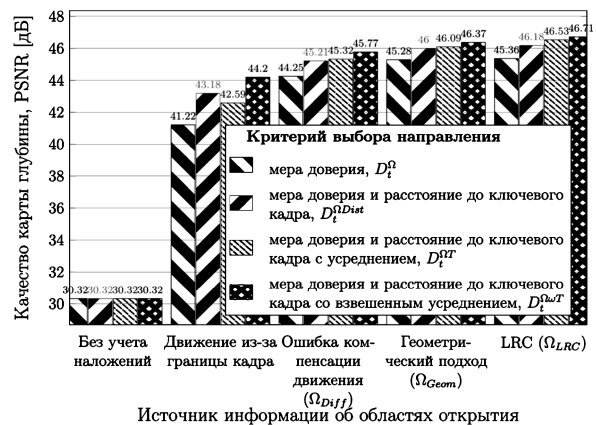
Рис. 7. Сравнение методов построения областей открытия по качеству распространения карты глубины с учетом областей открытия
