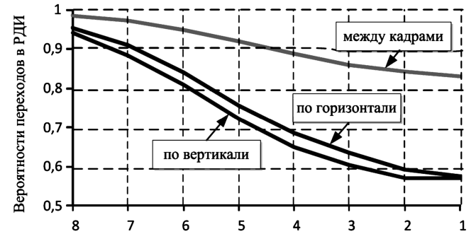
Рис. 2. Зависимости вероятностей переходов между состояниями элементов в последовательности РДИ (8 - старший разряд; 1 - младший разряд)
